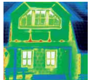
Après rénovation réduction des pertitions
